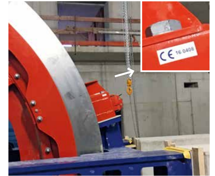
Antriebsseilscheibe mit Bremse für die neue Seilbahn Zugspitze mit CE-Kennzeichnung. Mit dieser Kennzeichnung bestätigt der Bremsenhersteller, dass die neue Seilbahnbremse den europäischen Vorgaben entspricht.
